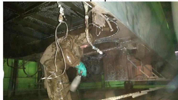
НЭРЗ. Наклоны работника, работа в неудобном состоянии при мойке кузова снизу
