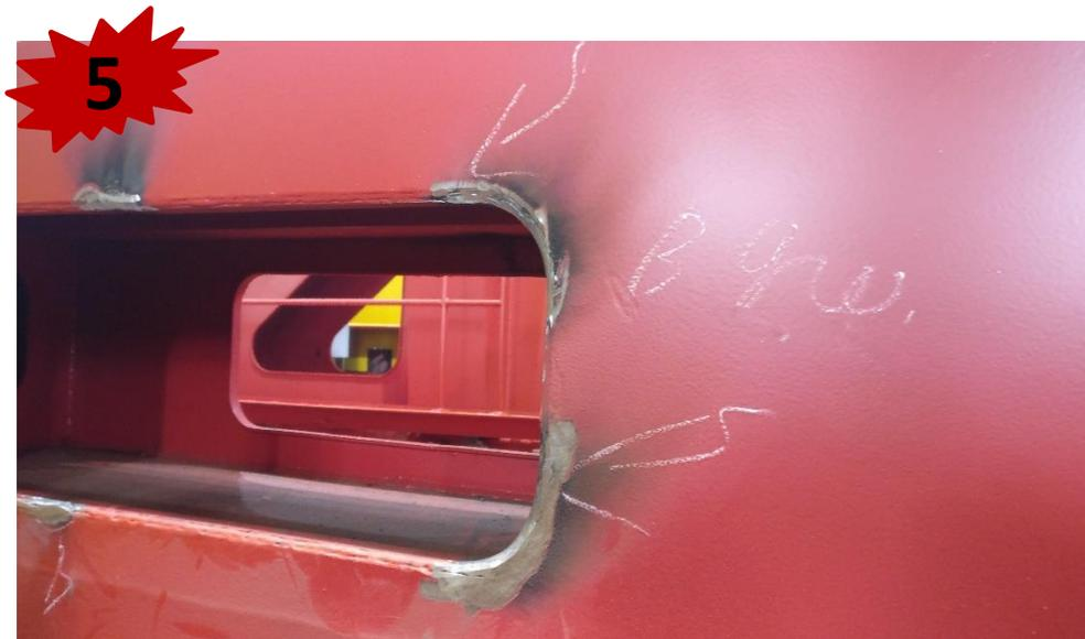
КПМ. Некачественная сварка обнаружена уже в окрашенном кране при сдаче ОТК
