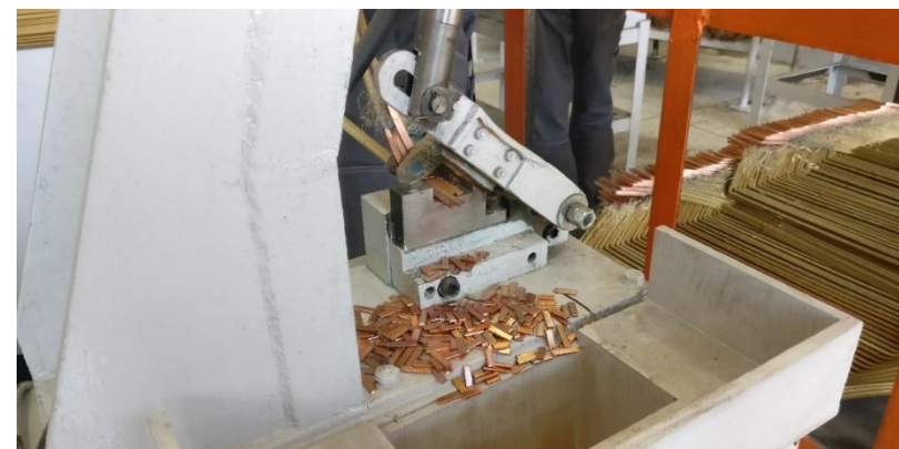
НЭРЗ. Избыточная очистка и лужение концов проводников, а затем их обрезка
